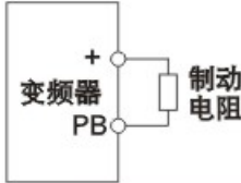
图5-1 制动电阻的安装
